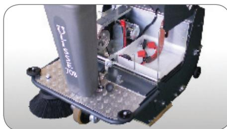
Facilité d'accès au moteur et à la batterie
