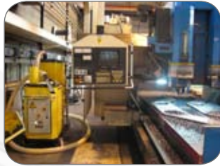
Aspiration des copeaux métalliques
