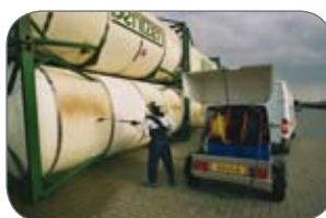
Nettoyage des citernes
