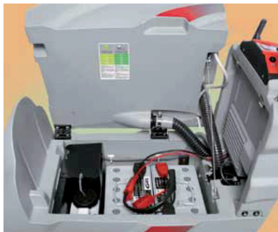
Détergents et batteries peuvent être logés dans un compartiment
